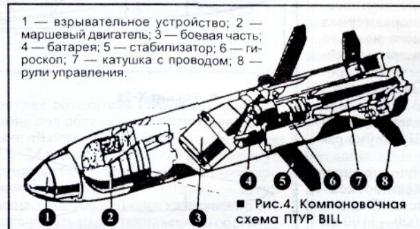
Рис.4. Компоновочная схема ПТУР BILL
