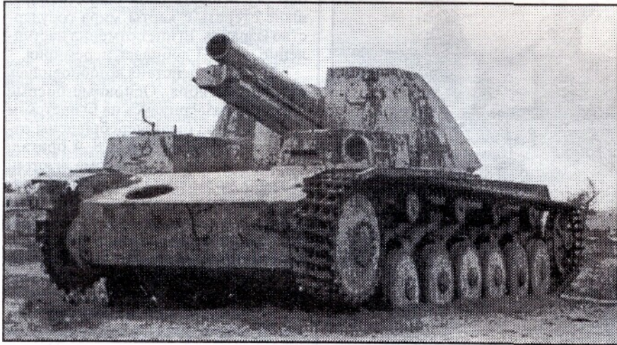
■ На фото показана одна из наиболее экзотических боевых машин армии Египта — немецкая 150-мм САУ на базе легкого танка Pz.II
