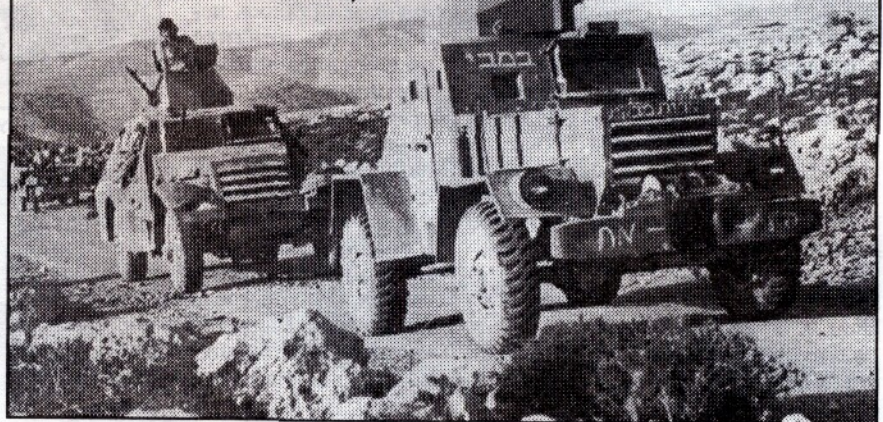
■ Израильские бронеавтомобили на марше. На первом плане — БА на базе автомобиля «Додж», на заднем плане — переделанный М3 «Скаут»
