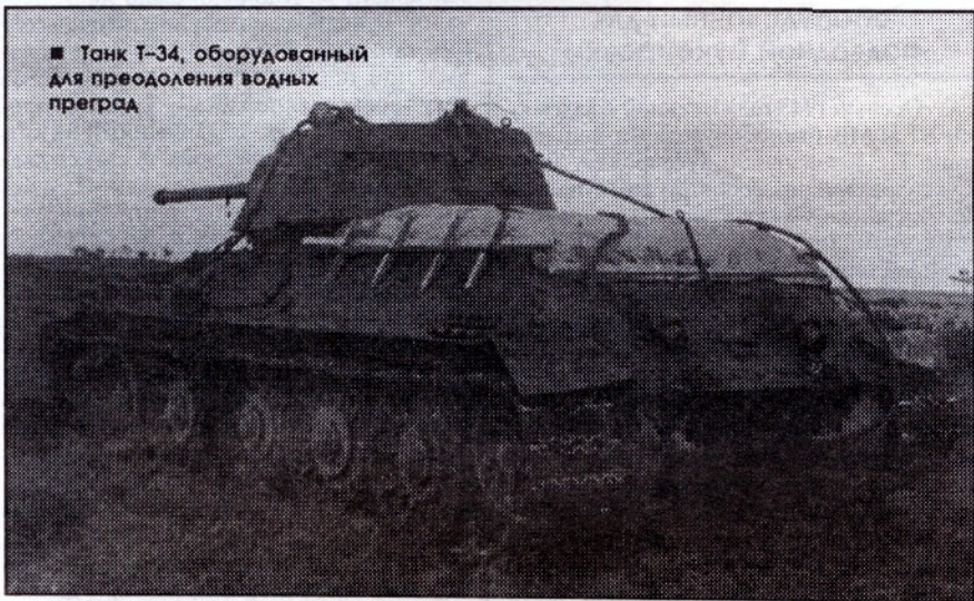
■ Выход на берег танка Т-34, переоборудованного для подводной буксировки
