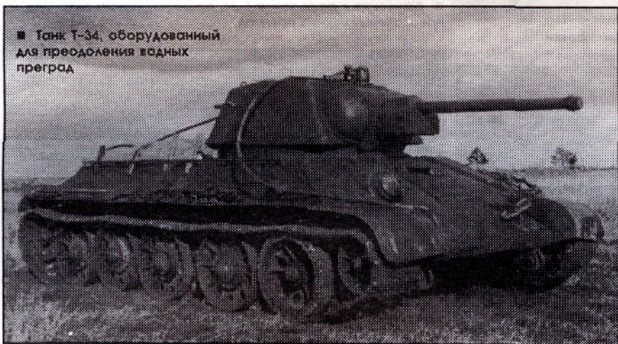
■ Танк Т-34, оборудованный для преодоления водных преград
